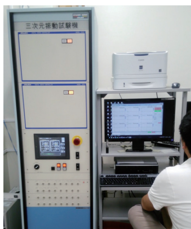
3次元振動試験機 コントロール部
